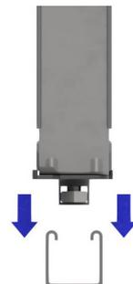
1) Senken Sie den Kabelhalter durch den Spalt im Kanal.
