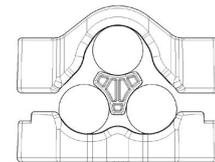
LA FORMA DE LAS ABRAZADERAS TRIDENT GARANTIZA QUE LOS CABLES SE MANTENGAN EN UNA VERDADERA FORMACIÓN DE TRÉBOL EN TODO SU RANGO DE TOMA, A DIFERENCIA DE LAS ABRAZADERAS POLIMÉRICAS SIMILARES DEL MERCADO. LAS FORMACIONES DE TRÉBOL DESIGUALES PUEDEN CAUSAR UNA CAÍDA DE TENSIÓN ADICIONAL.
