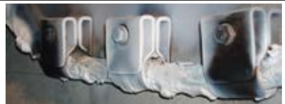
Los sujetadores Phoenix han sido probados contra incendios de acuerdo con BS 5839-1: 2017.
