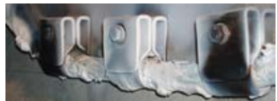
Phoenix-Halterungen wurden gemäß BS 5839-1 auf ihr Brandverhalten geprüft: 2017.
