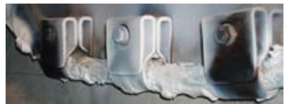
Les clips Phoenix ont été testés contre les incendies conformément à la norme BS 5839-1: 2017.
