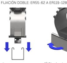
1) Coloque la abrazadera a través del orificio en el canal.
