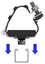
1) Coloque la abrazadera a través del orificio en el canal.
