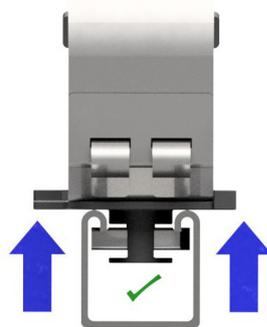
4) Conforme os parafusos forem apertados, as roscas de canal irão mover para cima da base giratória e aderir ao canal.
