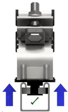
4) Enquanto o parafuso é apertado a placa roscada da canaleta levantará a base da sapata giratória e prenderá à placa.
