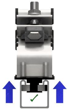
4) Al apretar el tornillo, la tuerca del canal subirá por la base del Twist Foot y se sujetará al canal.
