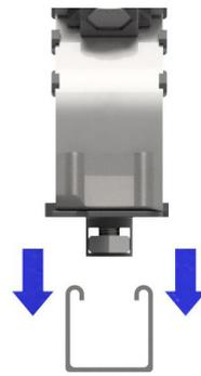
1) Coloque la abrazadera a través del orificio en el canal.
